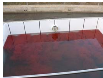
5d. En menos de 15 segundos llega al final del depósito y a las paredes
